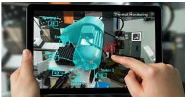
*Figura 7: Apprendimento in contesto lavorativo "aumentato". Un tablet inquadra un motore elettrico ed evidenzia le varie parti permettendo una sorta di "smontaggio" e "rimontaggio" virtuale.*
